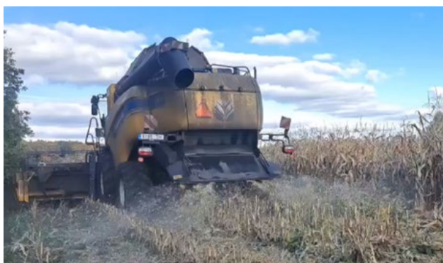
3. ja 4. foto. Maisi koristamine teramaisina teraviljakombaini heedri abil ühes piloottalus.
