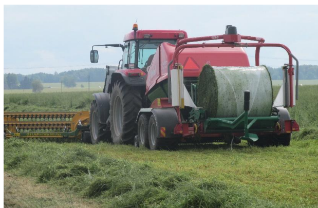
Rohumassi vaalutab, kogub vaalust, pressib rulliks ja mähib kilesse üks agregaat.
