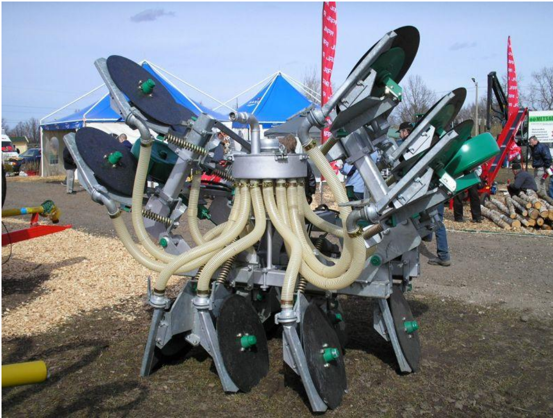
Joonis 3.28. 1-kettaline kaldne avalõhe-sisestusseadis (Foto: R. Vettik)
