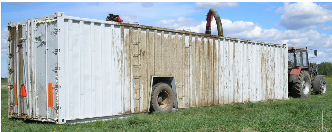
Joonis 3.10. Merekonteinerist valmistatud teisaldatav vahemahuti (Foto: R. Vettik)
