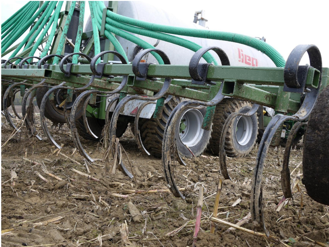
Joonis 3.25. Vedelsõnniku segamislaotur tüükultivaatoriga (Fliegl, 2016b)
