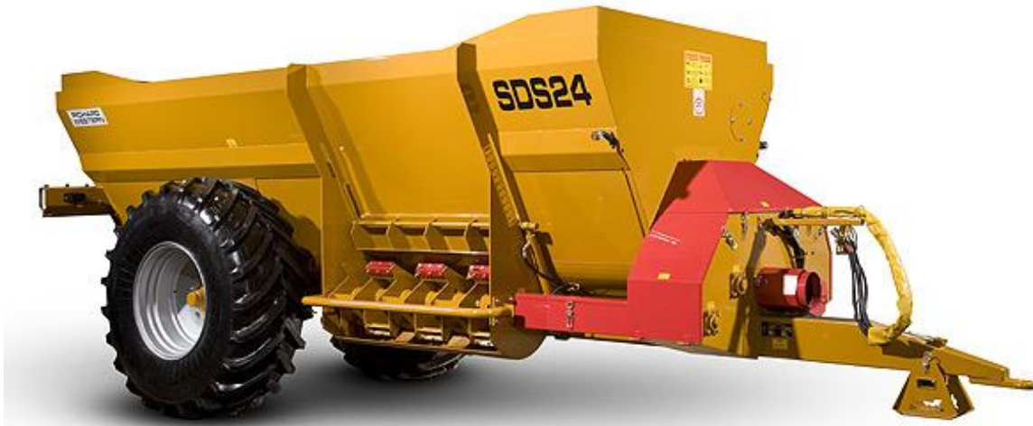
Joonis 3.36. Külgväljutuse ja punkermahutiga rootorlaotur sobib poolvedela sõnniku laotamiseks. Laoturi ratta ees on näha välimine osa laotamiseadmisest (Richard Western, 2012)
