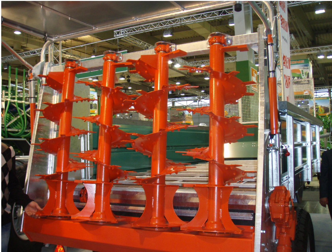
Joonis 3.2. Püstbiitritega tahalaotamiseade (Foto: R. Vettik)
