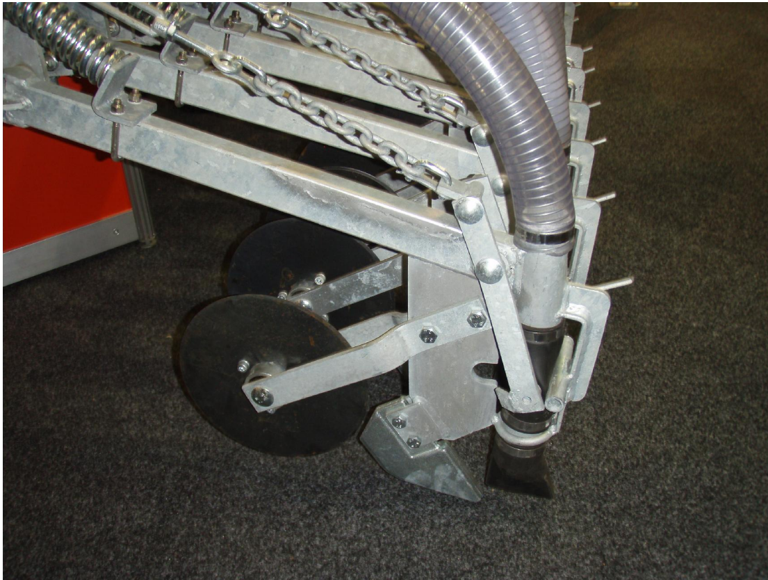
Joonis 3.30. 1-kettaline kiiluga avalõhe-sisestusseadis (Foto: R. Vettik)
