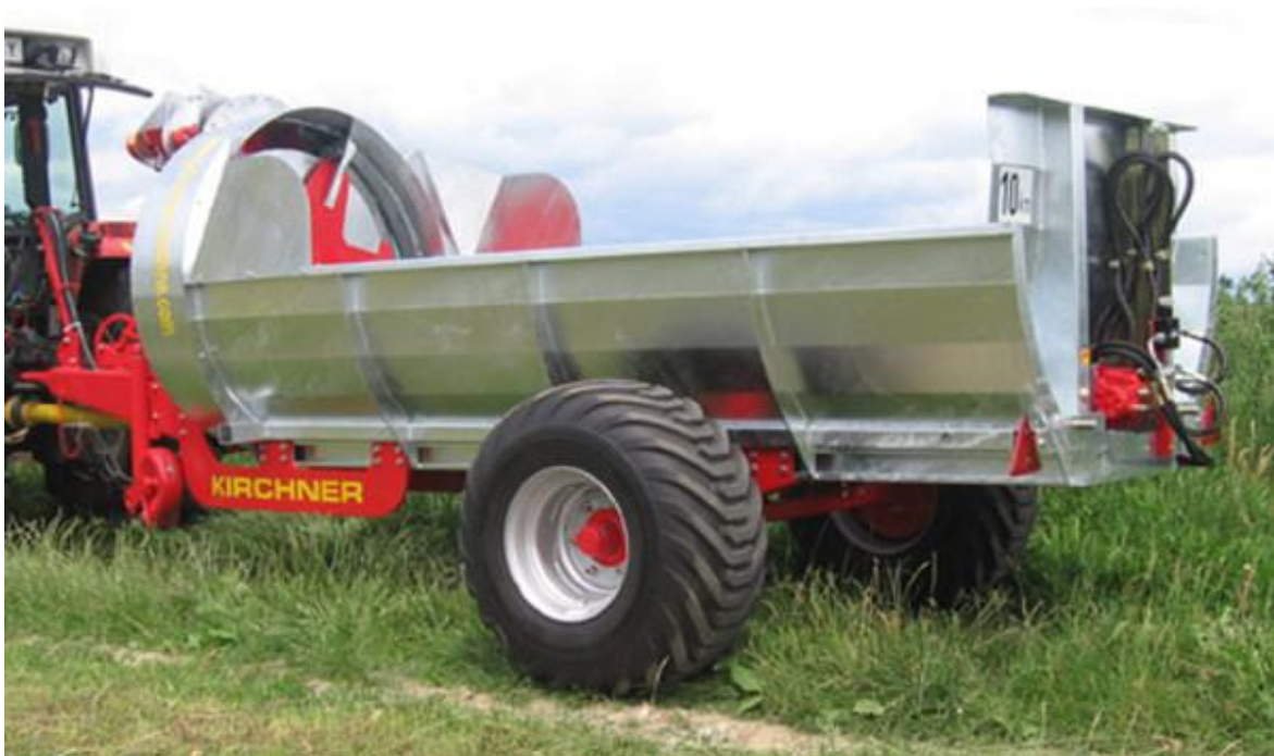
Joonis 3.6. Külglaoamisega rootorlaotur (Kirchner, 2016)
