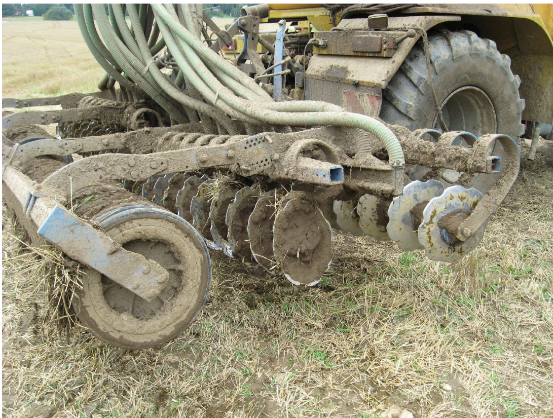
Joonis 3.26. Vedelsõnniku segamislautur ketasseadmega (Foto: K. Tamm)
