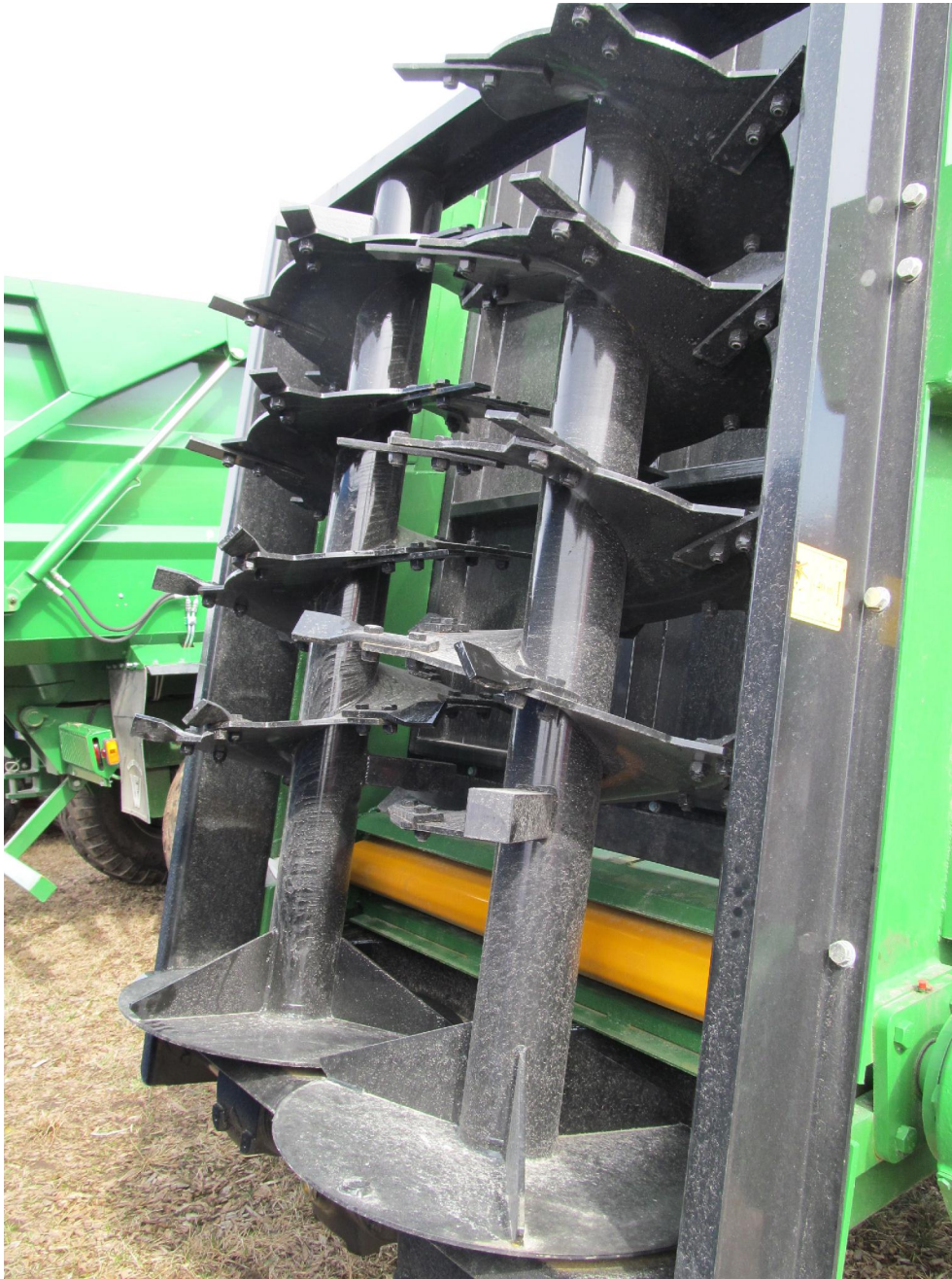
Joonis 3.3. Püstbiitrite ja ketastega tahalaotamiseade (Foto: R. Vettik)
