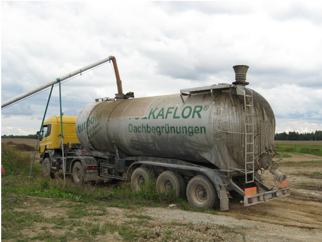
Joonis 3.9. Paakpoolhaagis vedelsõnniku etteveoks, toimub paakhaagise täitmine hoidla juures (Foto: K. Tamm)
