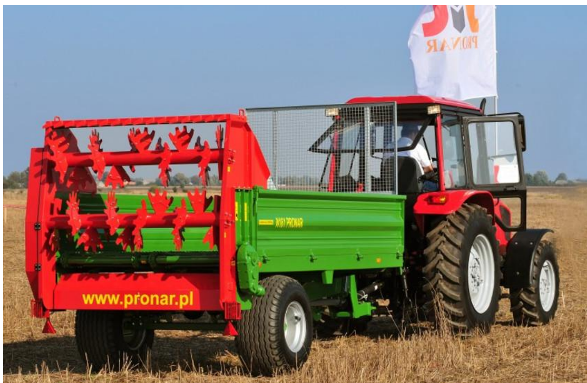
Joonis 3.1. Rõhtbiitritega tahalaotamisseade (Pronar, 2016)
