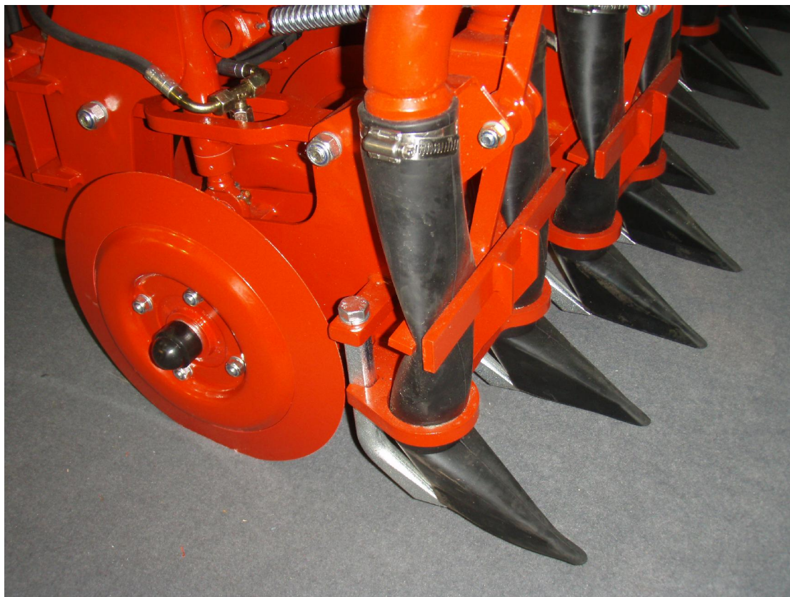
Joonis 3.27. 1-kettaline kesksuunas paksenev avalõhe-sisestusseadis (Foto: R. Vettik)
