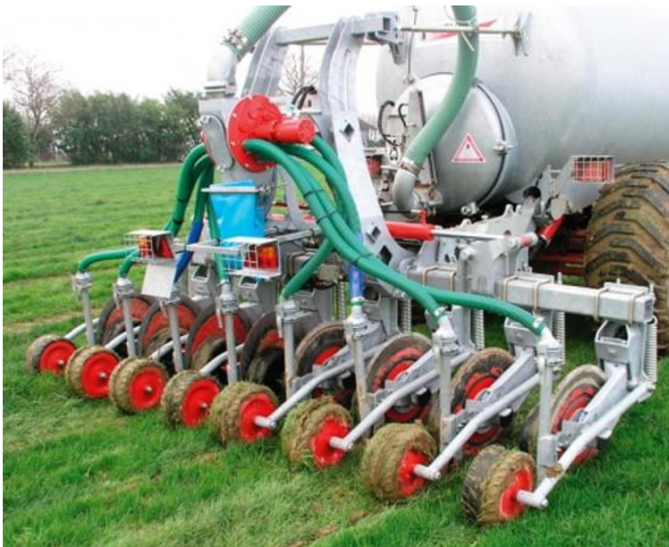
Joonis 3.32. Lõhed suletakse surverattaga (Pichon, 2016)
