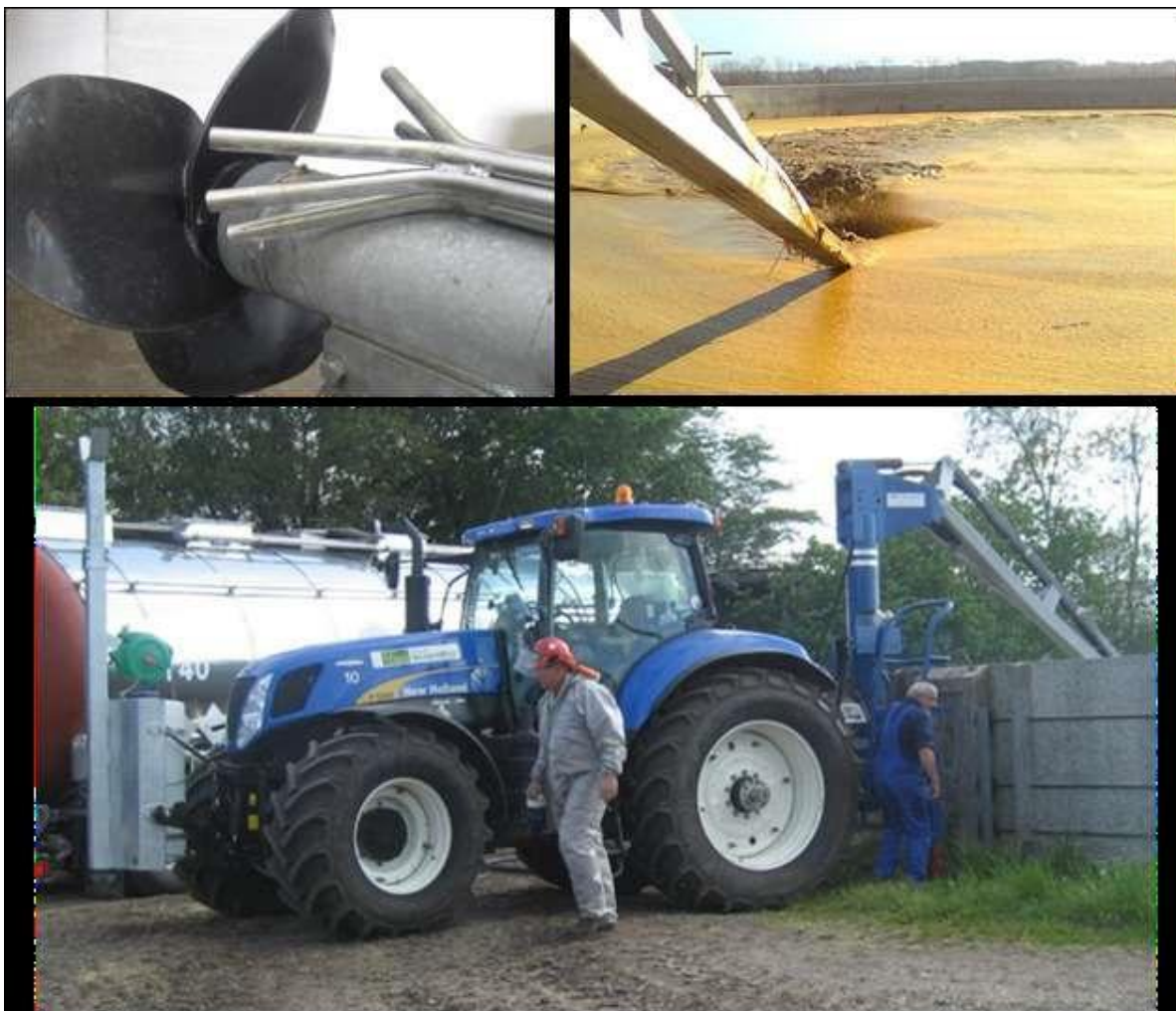
Joonis 5.3. Ørum TF-12 sõnniku hapestamise süsteem (Ørumsmeden A/S, 2016). Ülal vasakul happepihustid monteerituna Ørum GMD vedelsõnniku segurile. Ülal paremal sõnniku segamine ja hapestamine. All on Ørum TF-12 traktori taga rippes, traktori esirippüsteemil on ohutusnõuete tagamiseks puhta vee paak ja dušš. Traktori taustal on väävelhappe paakveok.
