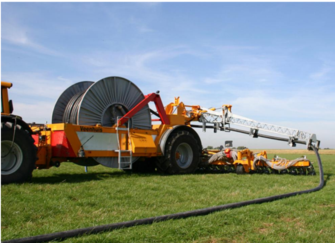
Joonis 3.16. Poolhaagis-voolikliotur (Veenhuis, 2016)
