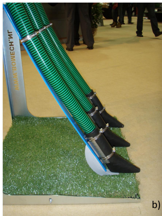
Joonis 3.24. Lohislaoturi voolikud on varustatud düüside (a), düüside ja juhtkiiludega (b) tagamaks vedelsõnniku andmine võimalikult maapinna lähedalt ning kitsa ribana (Fotod: R. Vettik)
