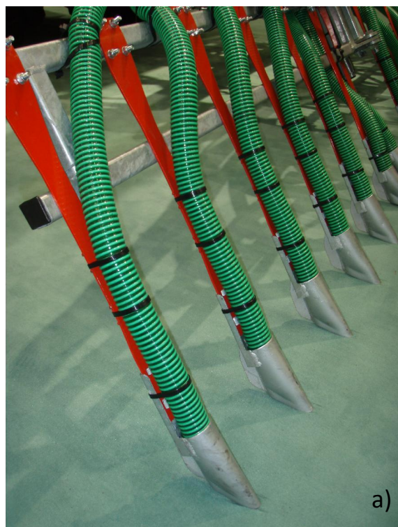
Joonis 3.24. Lohislaoturi voolikud on varustatud düüside (a), düüside ja juhtkiiludega (b) tagamaks vedelsõnniku andmine võimalikult maapinna lähedalt ning kitsa ribana (Fotod: R. Vettik)
