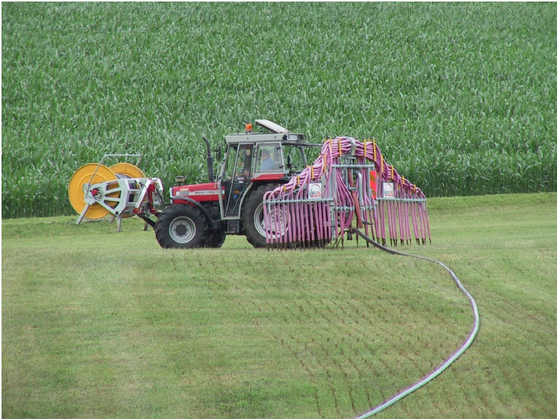
Joonis 3.15. Ripp-voolikliotur (Vacutec, 2016)
