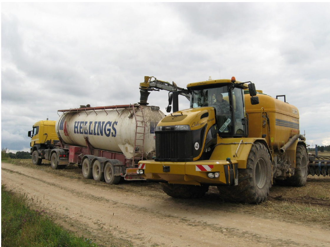
Joonis 3.12. Überpumpamine liikurlaoturi pumpamissüsteemiga (Foto: K. Tamm)
