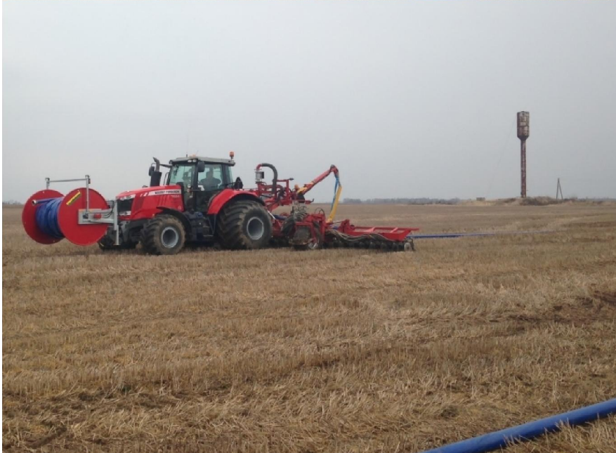
Joonis 5.7. Läti teenusepakkuja poolt kasutatav torutoitega vedelsõnnikulaotur (Foto: Aragro)
