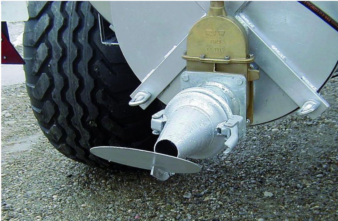
Joonis 3.19. Deflektoriga paiskur (Fliegl, 2016a)
