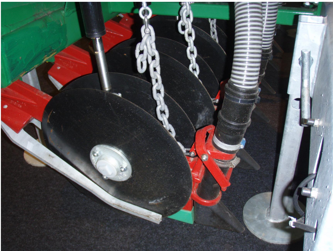
Joonis 3.29. 2-kettaline avalõhe-sisestusseadis (Foto: R. Vettik)
