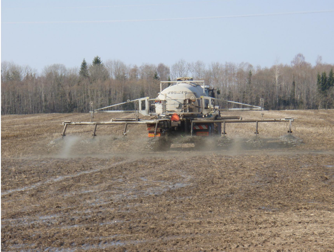
Joonis 3.22. Mitme poomil paikneva paiskuriga laotur (Foto: R. Vettik)
