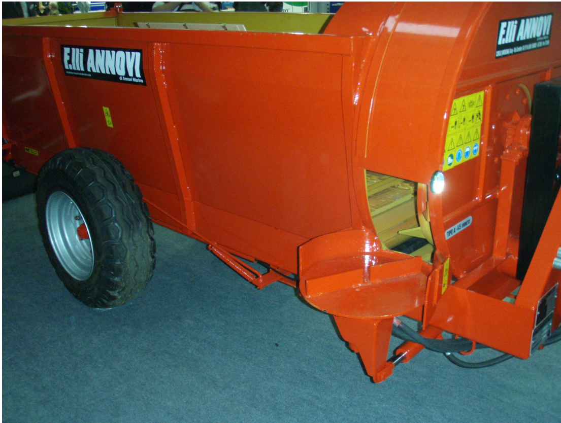
Joonis 3.7. Küljel paikneva laotamiskettaga laotur (Foto: R. Vettik)
