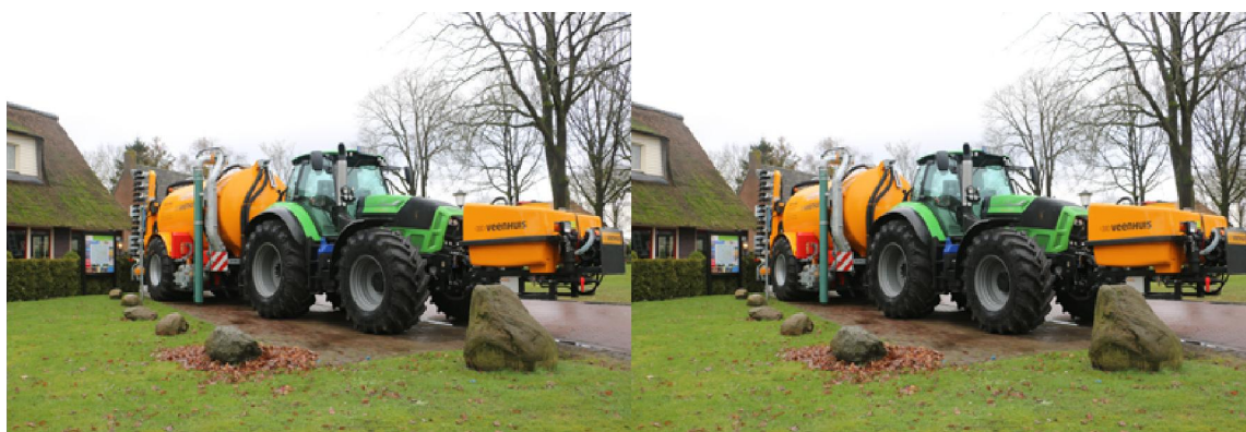
Joonis 5.10. Vedelväetise paak vedelsõnniku agregaadis oleva traktori esirippüsteemil (Veenhuis, 2016b).
