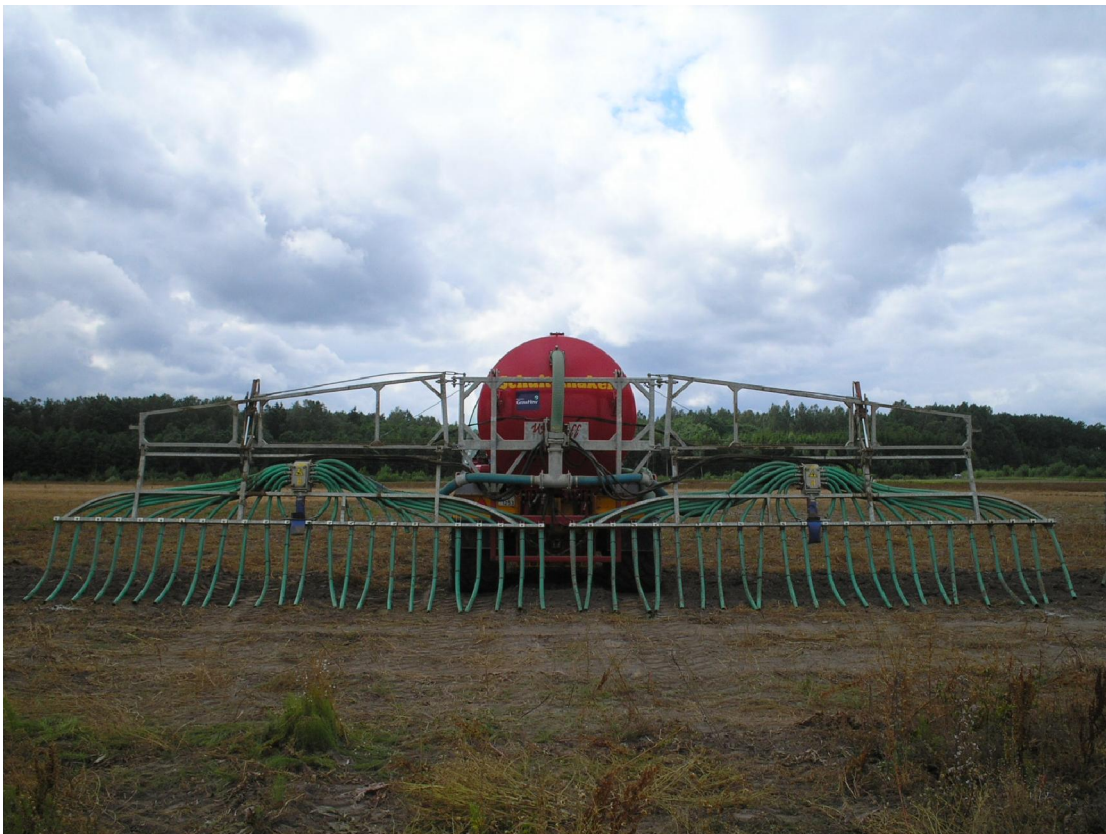
Joonis 3.23. Lohisvooliklaotur tagantvaates (Foto: R. Vettik)
