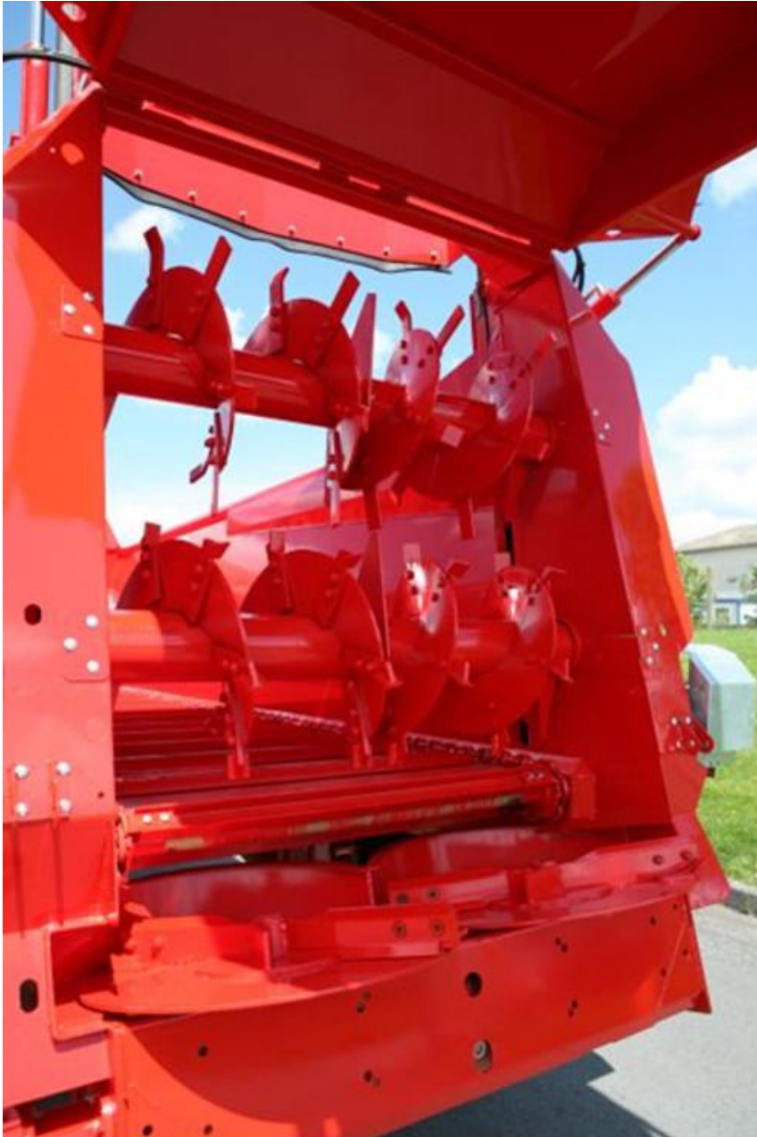
Joonis 3.38. Ketaslaotamisseadmega kastlaotur. Ülemise biitri kohal on näha vootõkke alumine serv koos kummitihendiga. Tootja väitel sobib laotur nii vedel- kui tahesõnniku laotamiseks (Jeantil, 2016)
