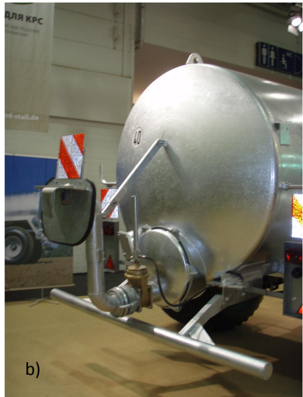
Joonis 3.21. Paiskesuuna muutmisvõimalusega paiskur (Möscha, 2016) (a) ja püstsuuriga paiskur (Foto: R. Vettik) (b)
