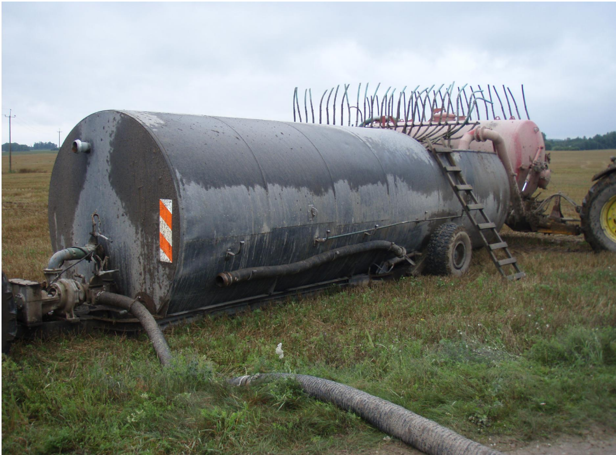
Joonis 3.11. Teisaldatav pumbaga vahemahuti. Taustal transpordiasendis lohisvoolikutega laotur pumpab vahemahutist vedelsõnnikut oma paaki. Esiplaanil oleva vooliku kaudu pumbatakse veeki paagist vedelsõnnik vahemahutisse (Foto: R. Vettik)
