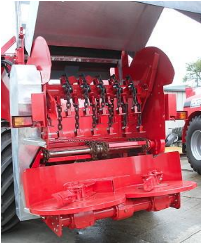
Joonis 3.5. Rõhtse kootbiitri ja laotamisketastega tahalaotamiseade (HiSpec, 2016a)
