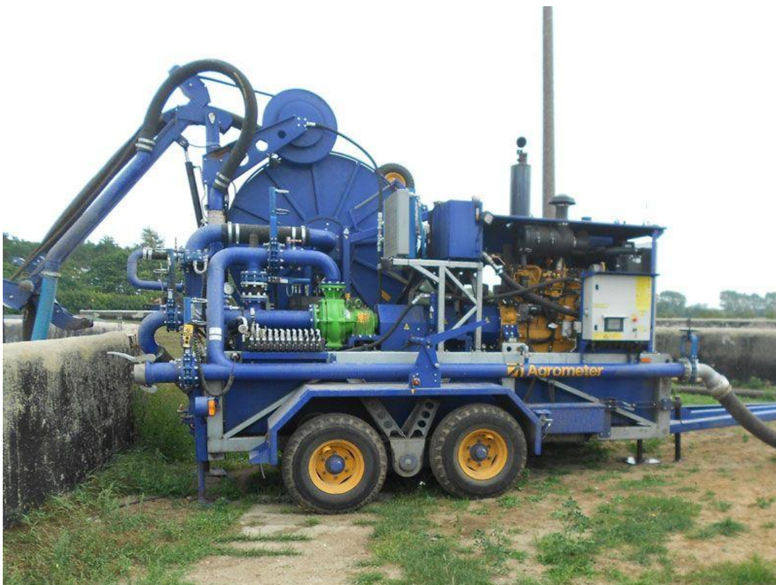
Joonis 3.14. Vooliktehnoloogia korral kasutatav pump (Agrometer, 2016a)
