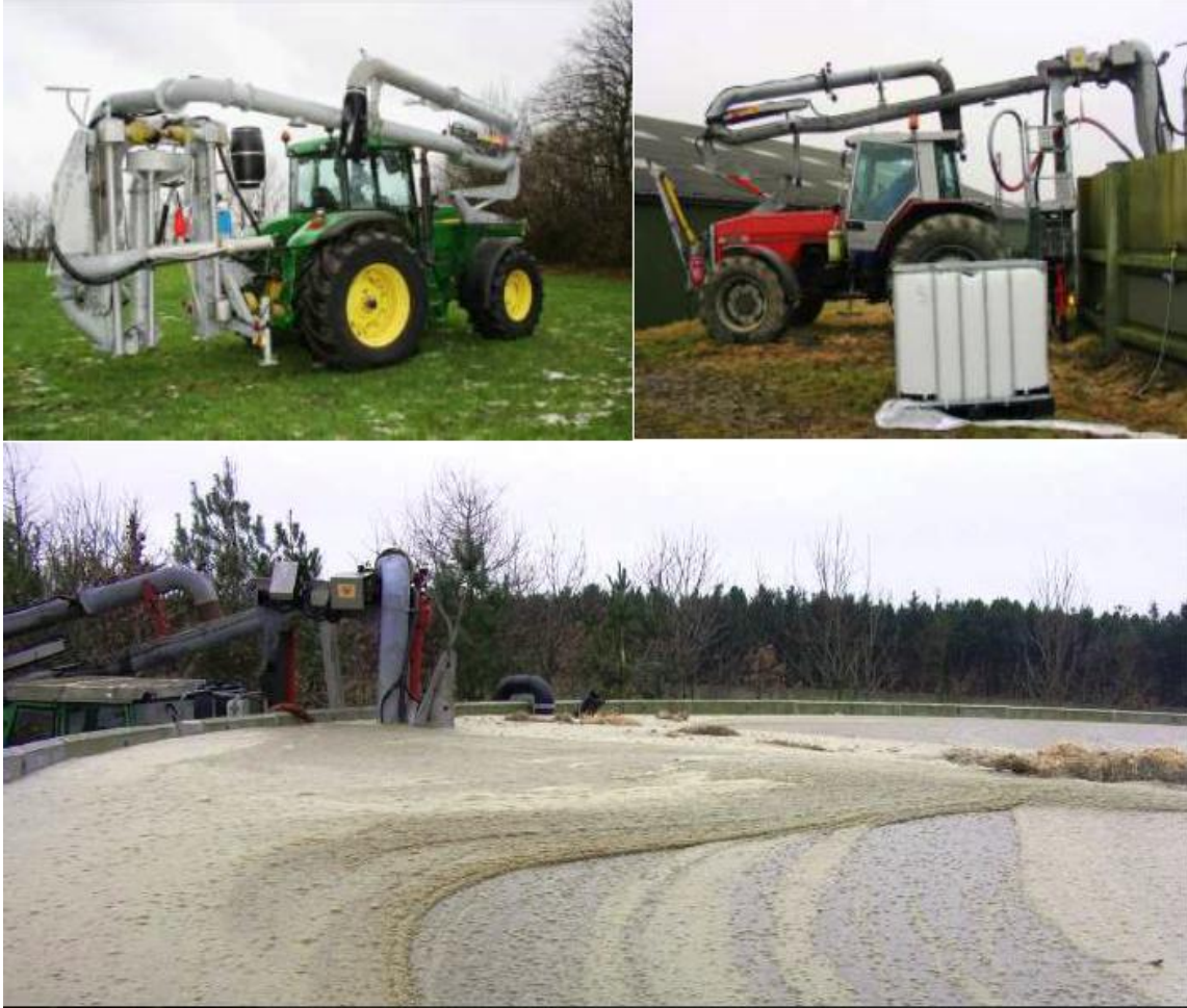
Joonis 5.2. Harsø Maskiner vedeslõnniku hapestamise ja segamise süsteem (Harsø Maskiner, 2016).
