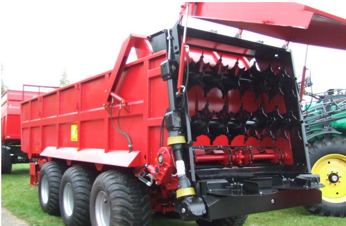
Joonis 3.4. Rõhtbiitrite ja ketastega tahalaotamisseade (LMR, 2016)
