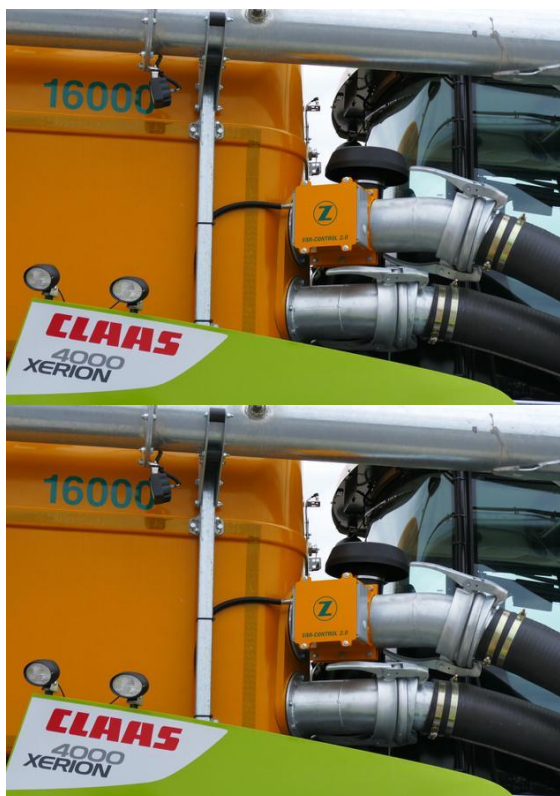
Joonis 5.9. NIR-andur (Z) monteerituna vedelsõnniku laoturile (vasakul) või pumpamiseseadmele (paremal), et teha sõnnikus olevate toiteainete sisalduse mõõtmisi reaalajas (Zunhammer, 2016).
