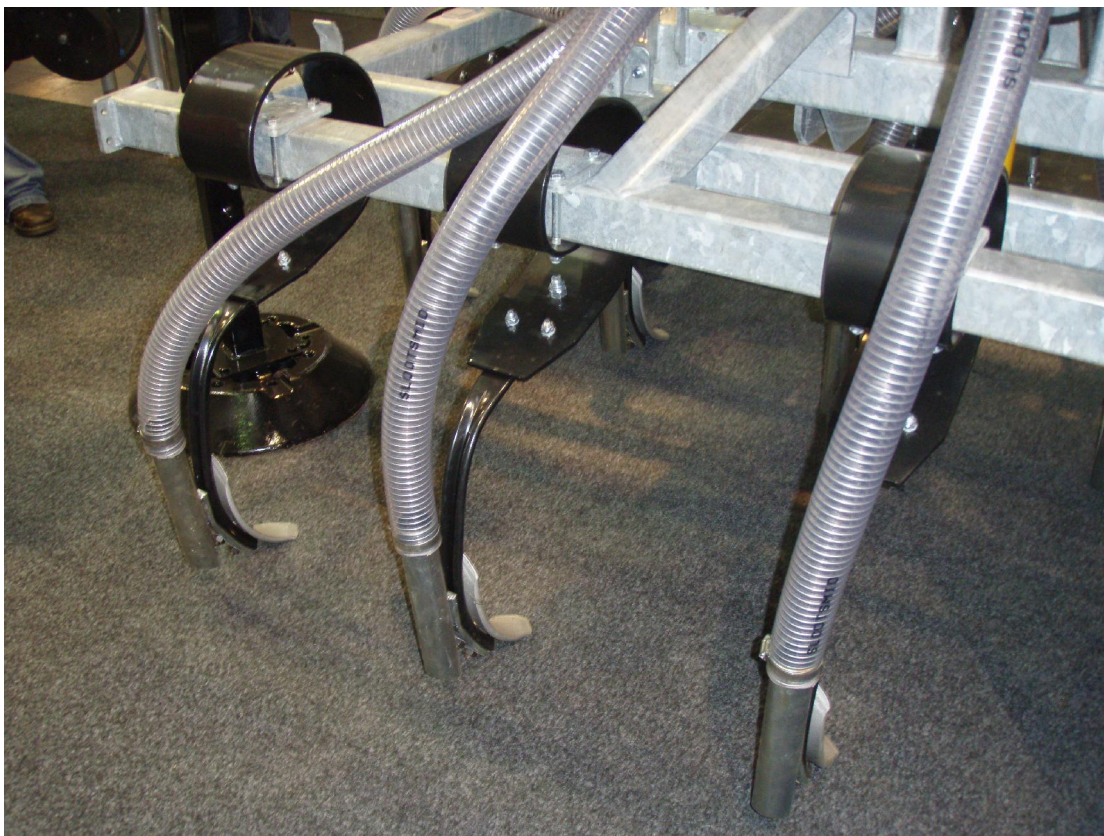
Joonis 3.33. Sügava muldaviimise kõbustuskäpad (Foto: R. Vettik)
