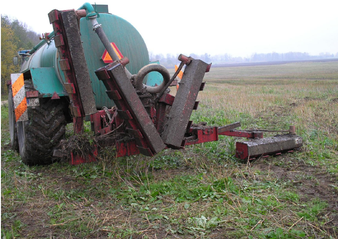
Joonis 3.31. Survelaotur, parempoolne laotamiseadis on tööasendis ja ülejäänud 3 transportiasendis (Foto: R. Vettik)
