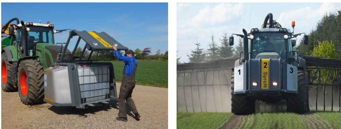
Joonis 5.5. Laotamisaegseks happe lisamiseks on traktori esirippüsteemile kinnitatud kolm paaki. Parempoolsel pildil: paak 1 raudsulfaadi, paak 2 väävelhappe ja paak 3 loputusvee (3) jaoks. (BioCover A/S, 2016)
