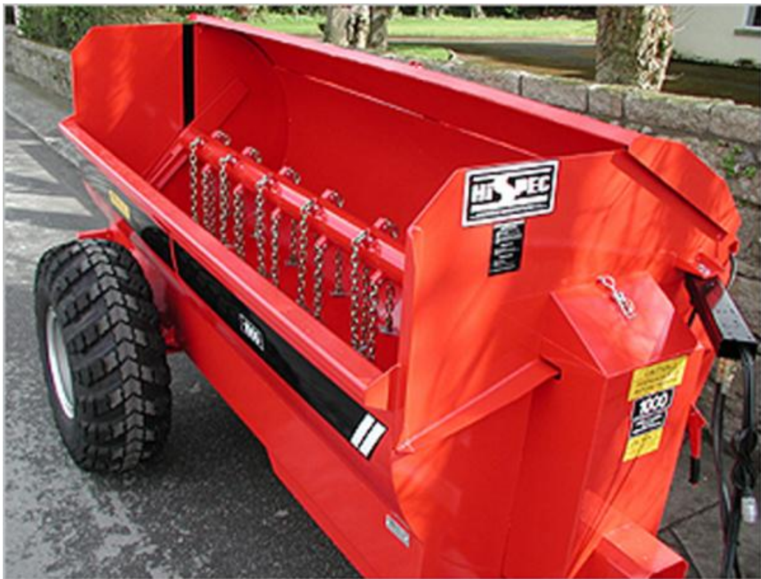
Joonis 3.8. Külglaoamisega pikibiitriga kootlaotur (HiSpec, 2016b)
