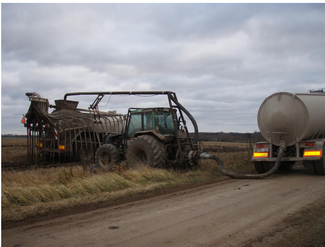
Joonis 3.13. Überpumpamine eraldi traktorile paigaldatud pumpamissüsteemiga (Foto: R. Vettik)
