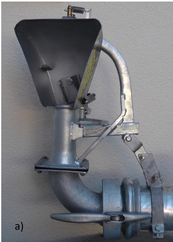
Joonis 3.21. Paiskesuuna muutmisvõimalusega paiskur (Möscha, 2016) (a) ja püstsuuriga paiskur (Foto: R. Vettik) (b)
