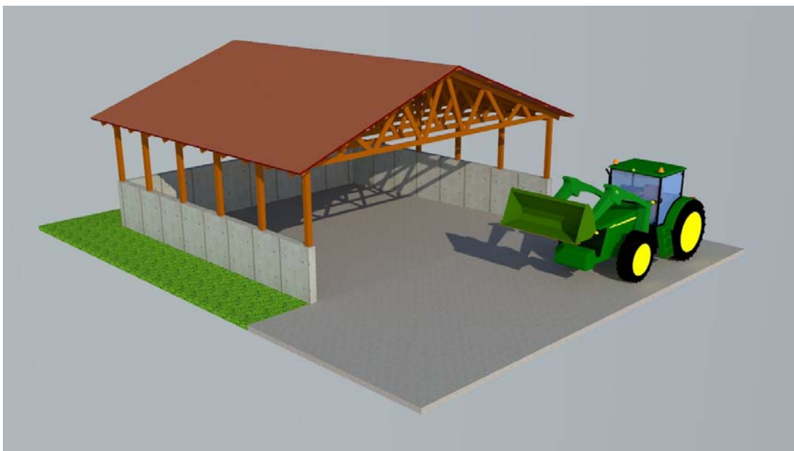
Joonis 16. III tüüpi tahesõnnikuhoidla eskiis
